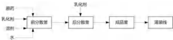
图1 水乳剂的工艺流程
