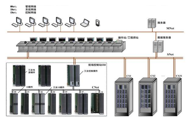
图 1 UW600 控制系统结构图
