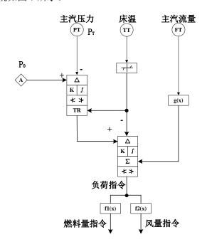
图 7 主汽压力控制系统图
